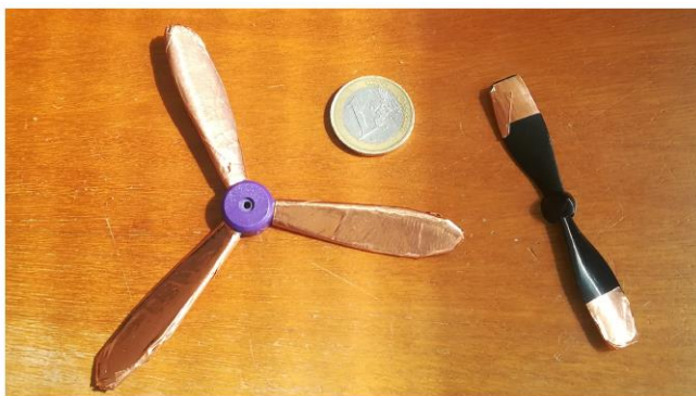
Figure 5 : Hélices à 2 et 3 pales recouvertes de cuivre pour augmenter leur réflectivité
